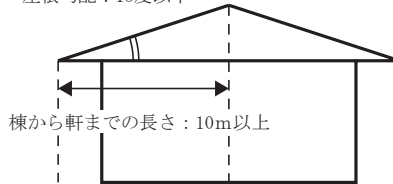
大スパン・緩勾配の屋根
