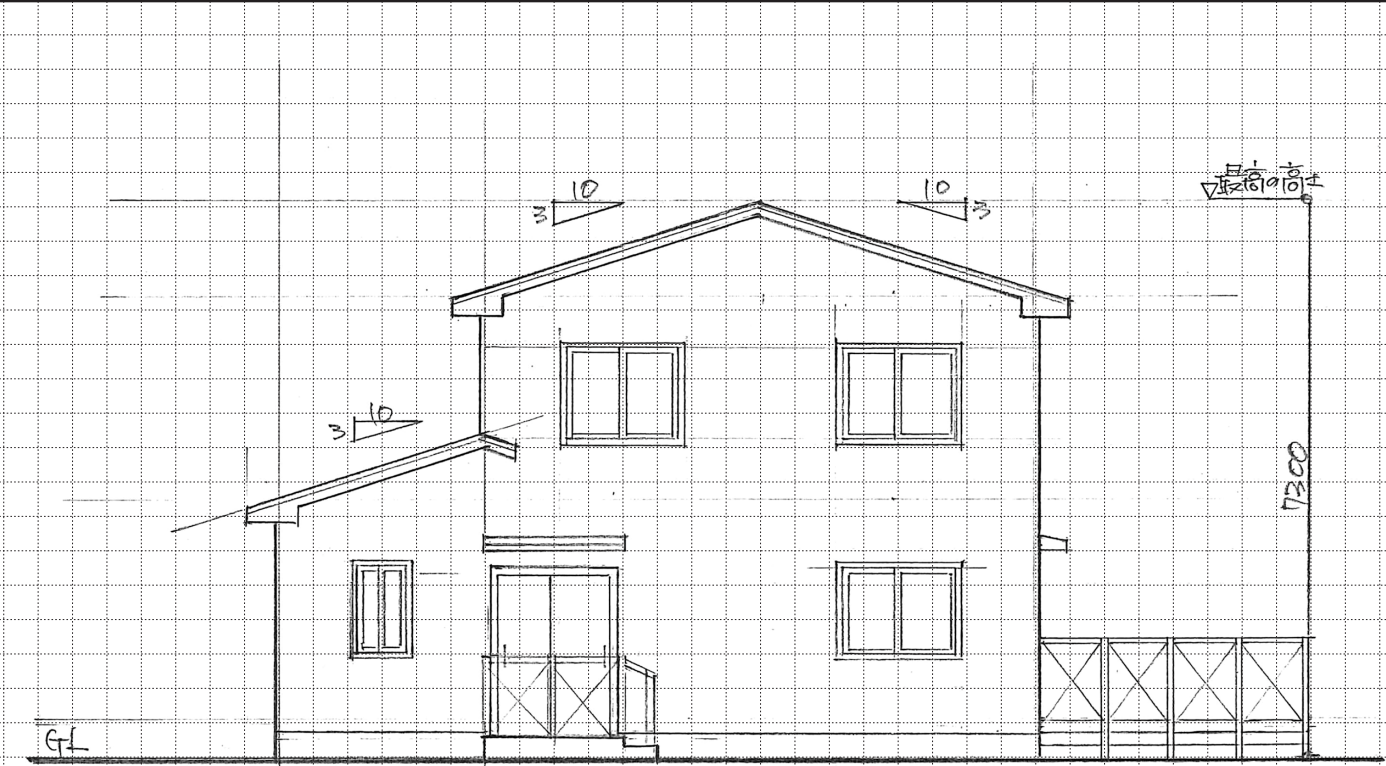
西側立面図 縮尺 1/100 (目盛4.55mm)
