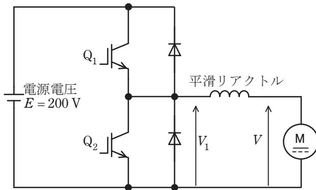
(a) この直流機を電動機として駆動する場合、 $Q_2$  をオフとし、 $Q_1$  をオンオフ制御することで、 $V$  を調整することができる。電圧  $V_1$  の平均値が 150 V のとき、1 周期の中で  $Q_1$  がオンになっている時間の値[ms]として、最も近いものを次の(1)～(5)のうちから一つ選べ。
